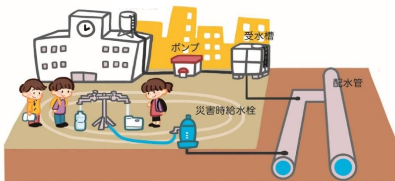
災害時給水栓の仕組み
