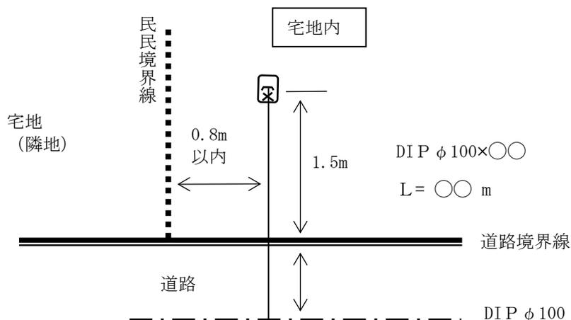
◎ 宅地内の先行取り出し給水管は、民境界から0.8m以内に埋設することを原則とし、道路境界（敷地境界）から1.5m付近に水道メーターボックス（丙止水栓）を設置する（ボックス内丙止水栓先キャップ止め）。
