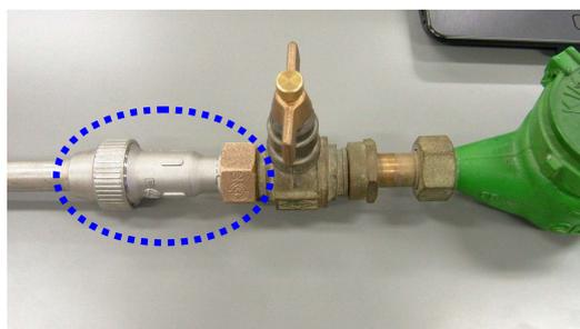
○ ※挿入したソケット（分水栓及び止水栓とCSST接続部）
