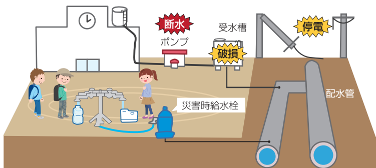
災害時給水栓の仕組み
