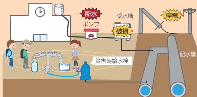
災害時給水栓の仕組み
