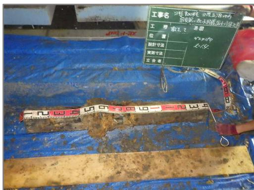
図 2.20 撤去したガス管
