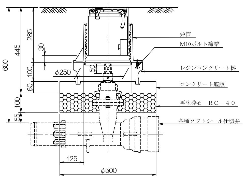
※1 仕切弁は、両受け、受け挿し、フランジ形とも使用可とする。
