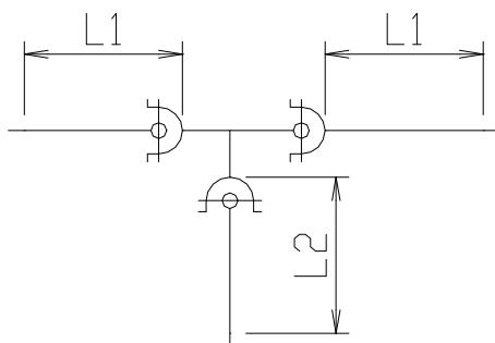
表 A-2-③ NS形 伏せ越し  $\phi 500 \sim \phi 700$ (設計水圧=1.1MPa)
