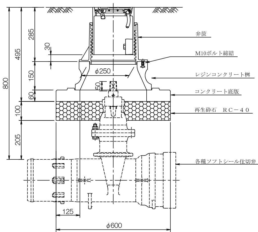
※1 仕切弁は、両受け、受け挿し、フランジ形とも使用可とする。
