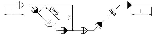
表 A-3-④その1 GX形 垂直Sベンド  $\phi$  75~ $\phi$  200(設計水圧=1.4MPa)
