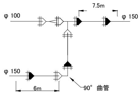
図 1 8 T字管+片落管+曲管
