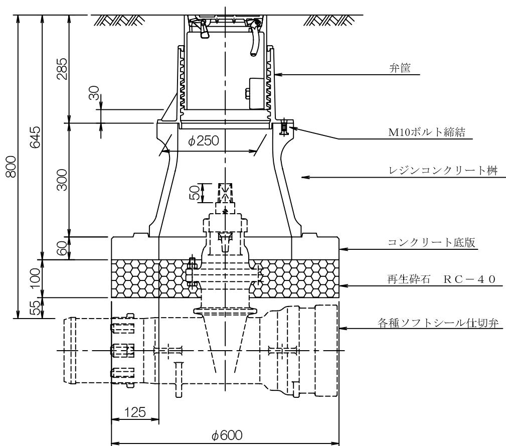
※1 仕切弁は、両受け、受け挿し、フランジ形とも使用可とする。
