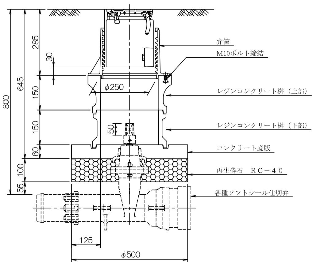
※1 仕切弁は、両受け、受け挿し、フランジ形とも使用可とする。
