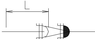
表F 仕切弁及び管端部[全ての継手形式に適用]
