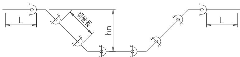
表 A-2-④ NS形 垂直Sペンド  $\phi 500 \sim \phi 700$ (設計水圧=1.1 MPa)
