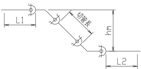
表A-3-① GX形, NS形 曲管  $\varphi 75 \sim \varphi 700$ (設計水圧=1.4MPa)
