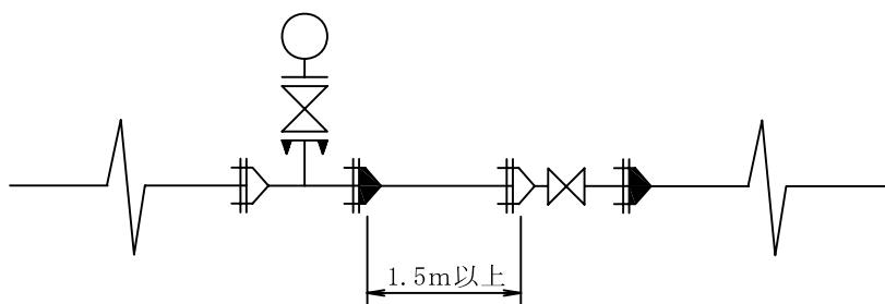
ゴム輪形硬質塩化ビニル管 ( $\phi 50 \sim \phi 100$ ) 離脱防止金具使用範囲
