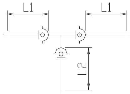
表 D-3-① 特殊押輪 曲管  $\phi 75 \sim \phi 700$ (設計水圧 = 1.4 MPa)
