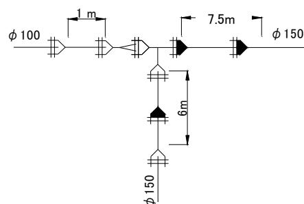
図 15 T字管 + 片落管
