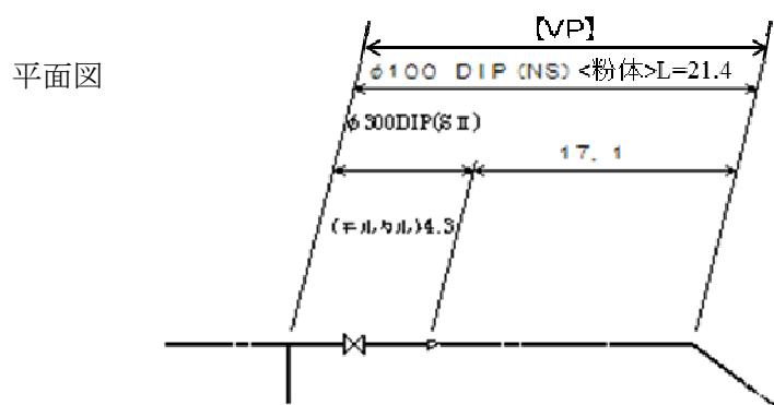
【例 3】平面図と配管詳細図の整合
