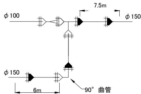
図 1-8 T字管+片落管+曲管
