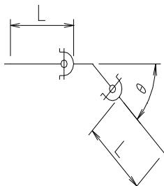
表 A-2-② NS形 T字管  $\phi 500 \sim \phi 700$ (設計水圧=1.1 MPa)
