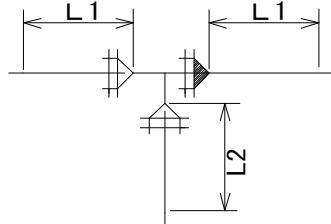
表 A-3-③ GX形及びNS形 伏せ越し  $\phi 75 \sim \phi 700$ (設計水圧=1.4 MPa)
