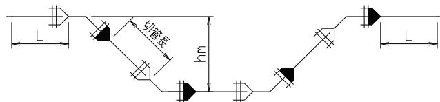
表 A-3-④その1 GX形 垂直Sベンド  $\phi 75 \sim \phi 200$ (設計水圧=1.4MPa)
