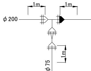
図 14 T字管 + 片落管
