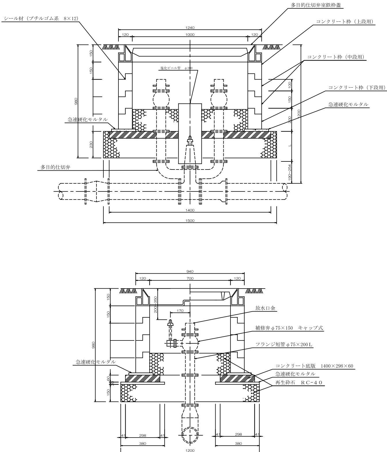
※ 高さ調整の必要な場合は、FCD製調整板及び急速硬化モルタルを使用する。
