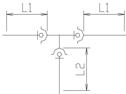
表 D-2-① 特殊押輪 曲管  $\phi 75 \sim \phi 700$  (設計水圧 = 1.1 MPa)
