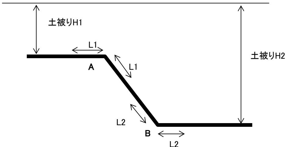
曲管Aの土被り $H_1$ での拘束長 $L_1$ 、曲管Bの土被り $H_2$ での拘束長 $L_2$ を求め、
