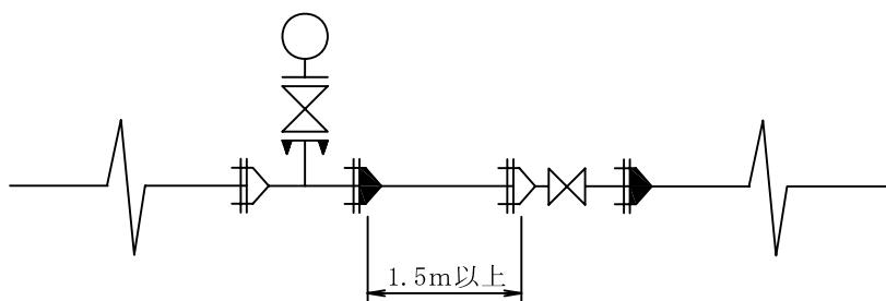
ゴム輪形硬質塩化ビニル管 ( $\phi 50 \sim \phi 100$ ) 離脱防止金具使用範囲
